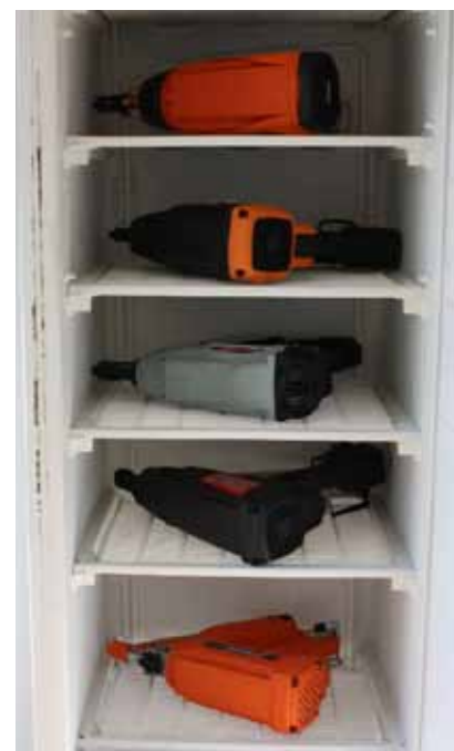
Efter tre timmar i frysen och -21C fick spikpistolerna bekänta färg och se om de fungerar även under extrema förhållanden.
