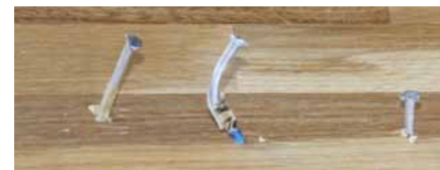
Trots att spikpistolerna är extremt kraftfulla är ek en aning för tufft även för dessa powermaskinerna.
