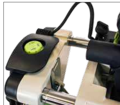
1. Vik upp höljet för att lätta på spärren som gör att du kan vrida på såghuvudet.
