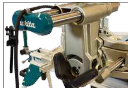
2. Stort vred på baksidan av maskinen som du måste lätta på när du ska vinkelsåga.
