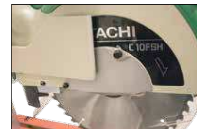
3. Du måste först lätta på skyddsplåten innan du kommer åt centrumbulten när du ska byta klinga.
