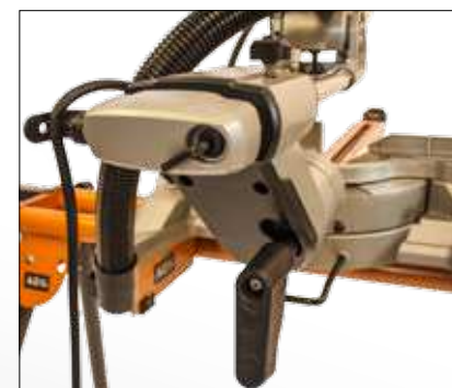
1. För att vinkelsåga måste du lossa på ett stort vred på baksidan av maskinen.
