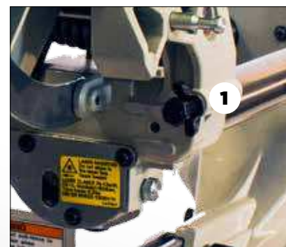
1. Krånglig lösning för att spärsa. Det blir mycket skruvande på ställskruven (1).
