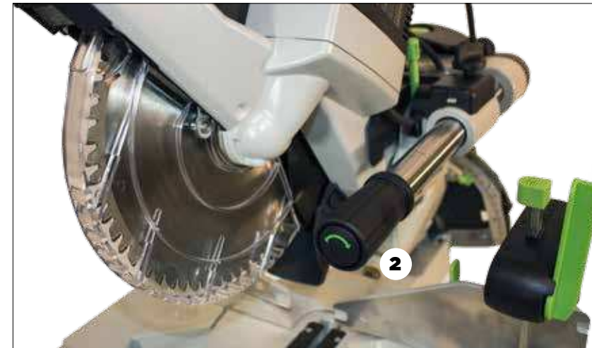
2. Mycket bra och smidigt handtag som underlättar gradinställningen vid vinkelsågning.
