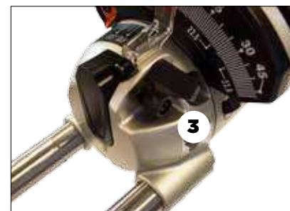
3. Svåråtkomlig spak för att ställa in de fasta vinklarna.
