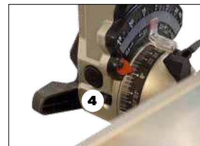
4. För att kunna vrida såghuvudet till höger måste du trycka in ytterligare en knapp.
