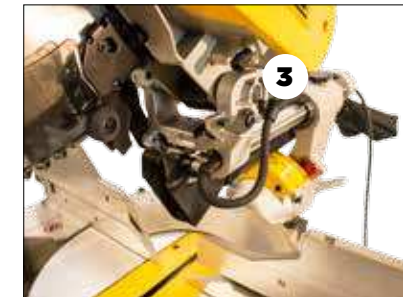
3. Svåråtkomlig ställskruv för att kunna ställa in sågdjupet vid spårsågning.
