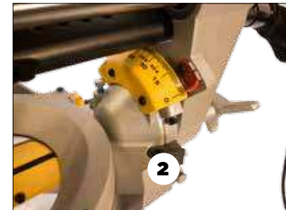
2. DeWalten har bara en fast vinkel som du ställer in genom att vrider fram en platta.
