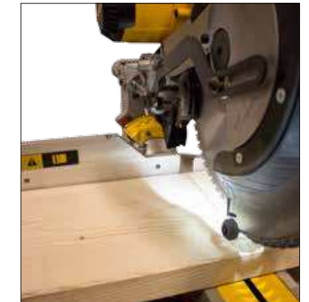
4. Istället för laser är det LED-ljuset som skapar en linje i materialet.
