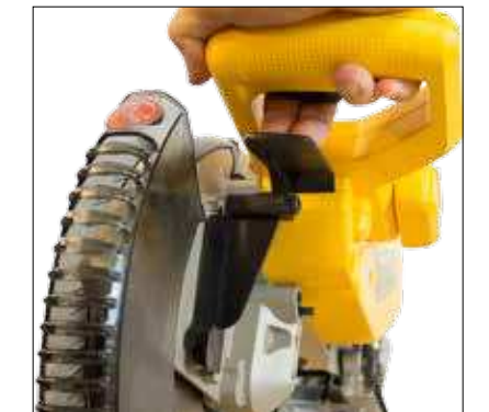
5. Momentet för att lätta på säkerhetspärren känns inte helt naturligt.
